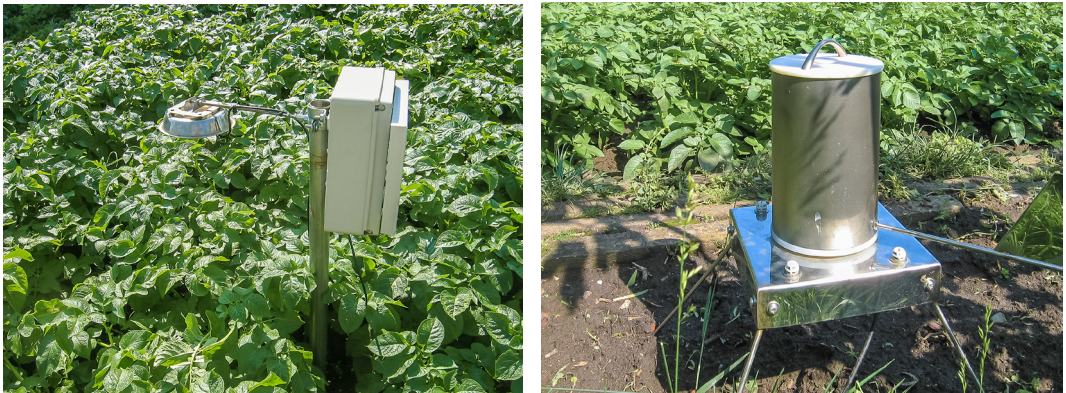
Obr. 1: Rotační (vlevo) a volumetrický lapač spor v porostu brambor
